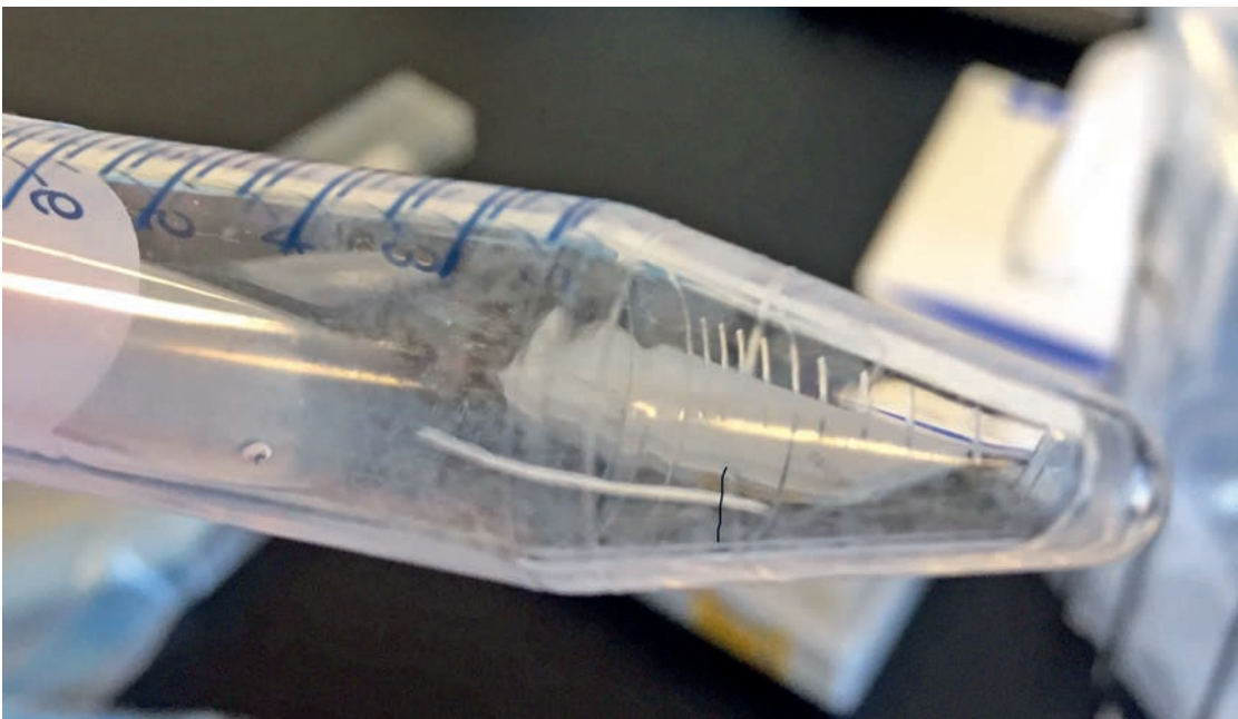
Afbeelding 1. Foto van gebarsten centrifugeerbuis uit Casus 1
